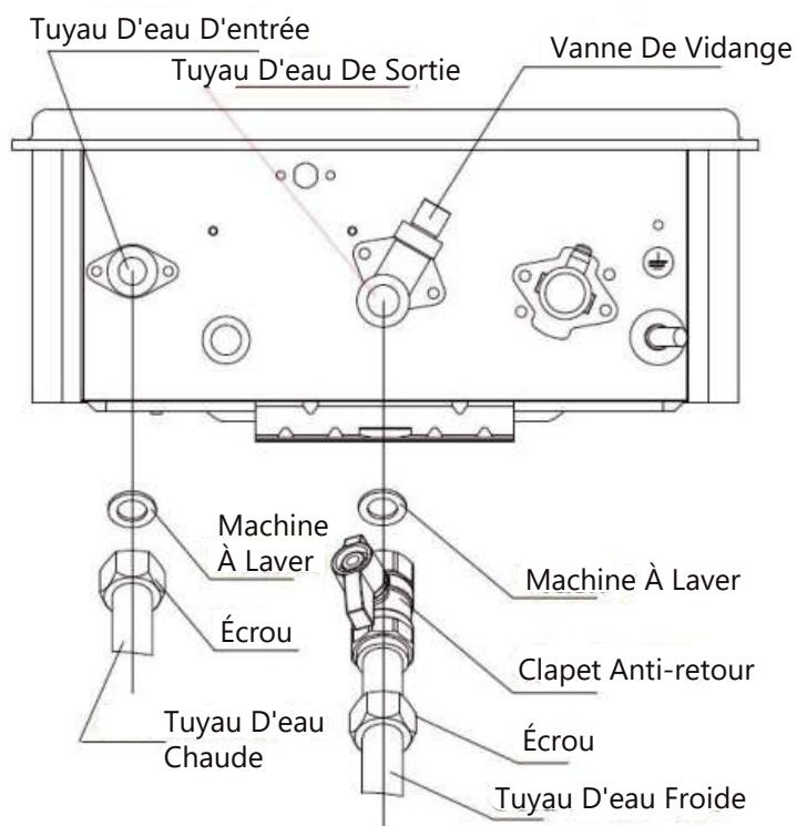
Installation d'isolation de tuyaux chauds et froids. Pour une efficacité énergétique accrue, utilisez un isolant de tuyau. Veuillez installer l'isolant, conformément aux illustrations ci-dessus, en veillant à l'isoler jusqu'en haut. Ne couvrez pas les vannes de vidange ou de pression.
