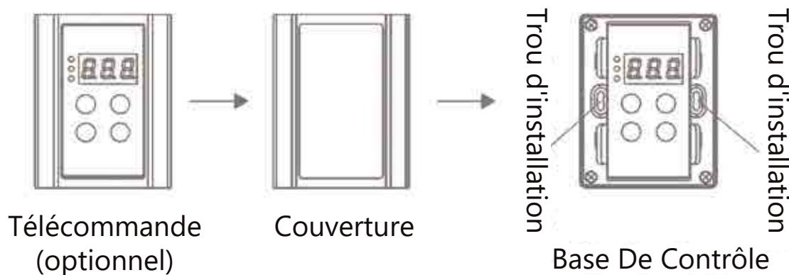
2. Sur le site d'installation, marquez et vissez deux trous de 0,24 "avec une profondeur de 1,2". Insérez 2 vis en caoutchouc dans les trous. Placez la télécommande contre le mur, alignez les orifices de la commande avec ceux du mur et fixez-les à l'aide de vis à bois. (Voir illustration ci-dessous)
