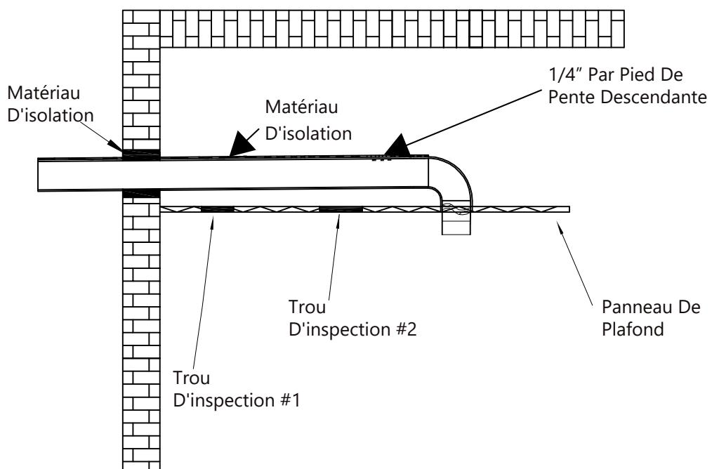
**AVIS:** Les tuyaux d'aération doivent être complètement isolés avec un matériau inflammable lors de l'installation dans des alcôves, des placards et des garages et ne doivent toucher aucun matériau inflammable.
