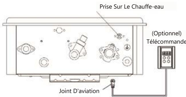
2. Pour deux commandes: Tout d'abord, coupez les joints d'aviation sur les deux contrôleur, branchez un dans la prise du chauffe-eau (la longueur dépend de vos besoins) et jetez l'autre. Connectez ensuite les fils du joint aviation au fil d'entrée du connecteur, puis connectez les deux télécommandes aux fils de sortie du connecteur.
